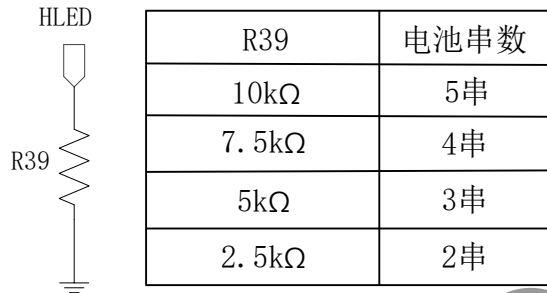
图 16 电池串数连接电路
